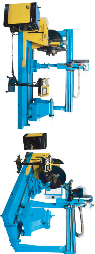
Установка для автоматической электродуговой наплавки под слоем флюса, а также в защитных газах и порошковыми проволоками крановых колес, опорных катков, валов, штоков, прокатных валков и др. деталей
