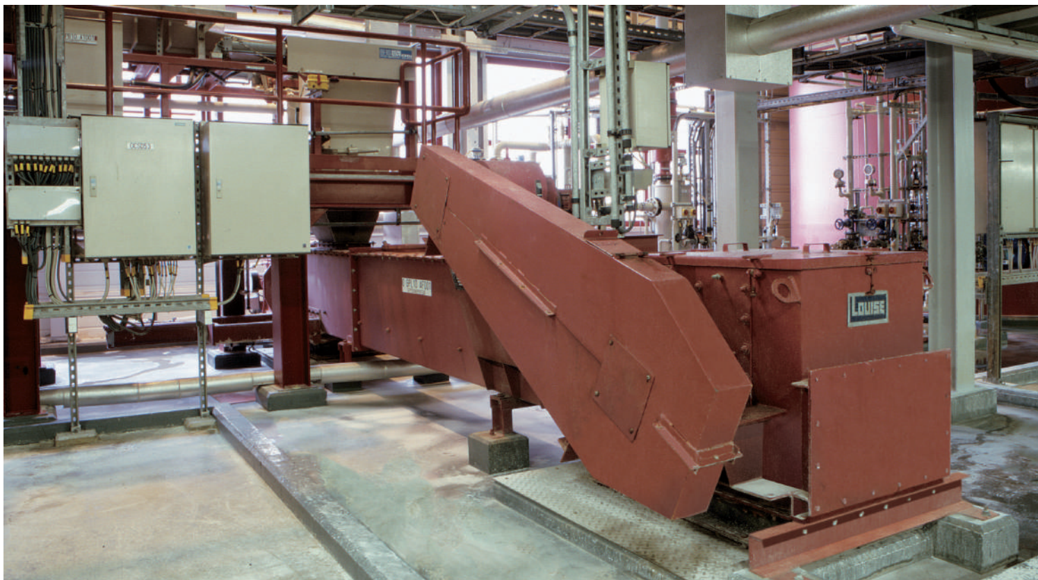
Цепной скребковый транспортёр LOUISE с двумя ветвями цепей, осуществляющий загрузку двух силосов.
