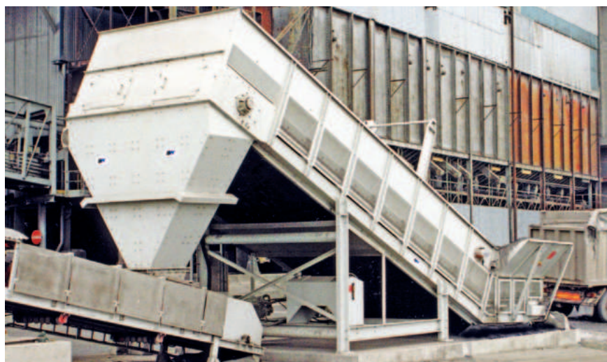
Питатель Samson® с центральной разгрузочной головкой на параллельно расположенный транспортер
