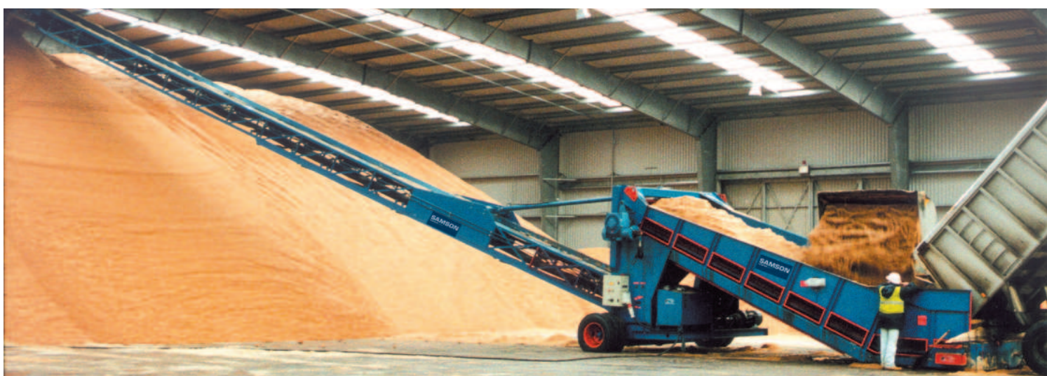
Укладчик Stormajor®, совмещает достоинства поверхностного питателя Samson® и поворотной стрелы укладчика, установленных на общем подвижном шасси
