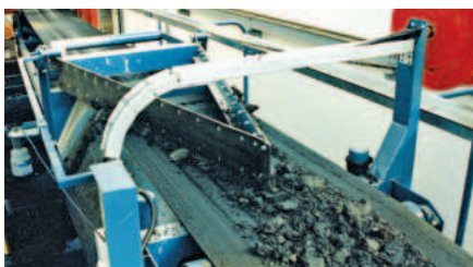
Питатель Samson® с горизонтальным накопительным бункером и подвесным транспортером со скребковым разгрузителем
