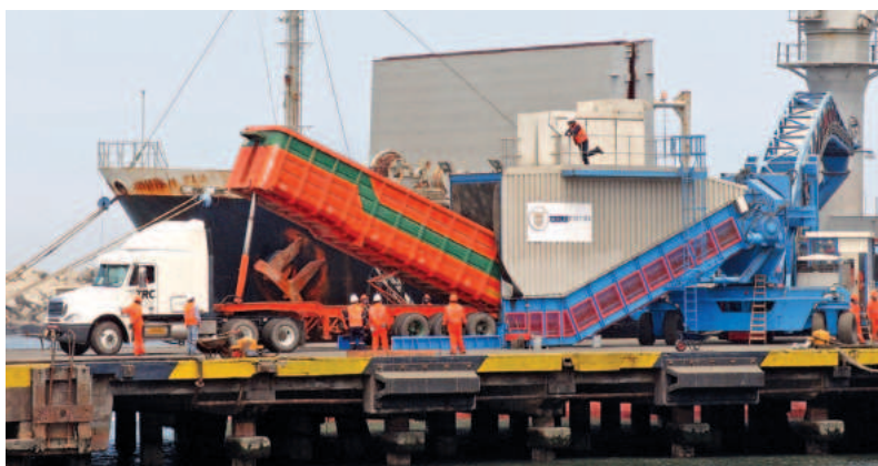
Питатель Samson® интегрированный с мобильным судовым погрузчиком принимает медную и золотую руды
