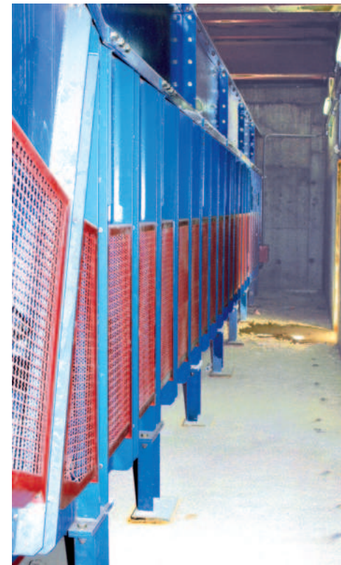
Разгрузочная установка для вагонов с донной разгрузкой, для приема угля на цементный завод, с питателем Samson® производительностью 80 т/ч
