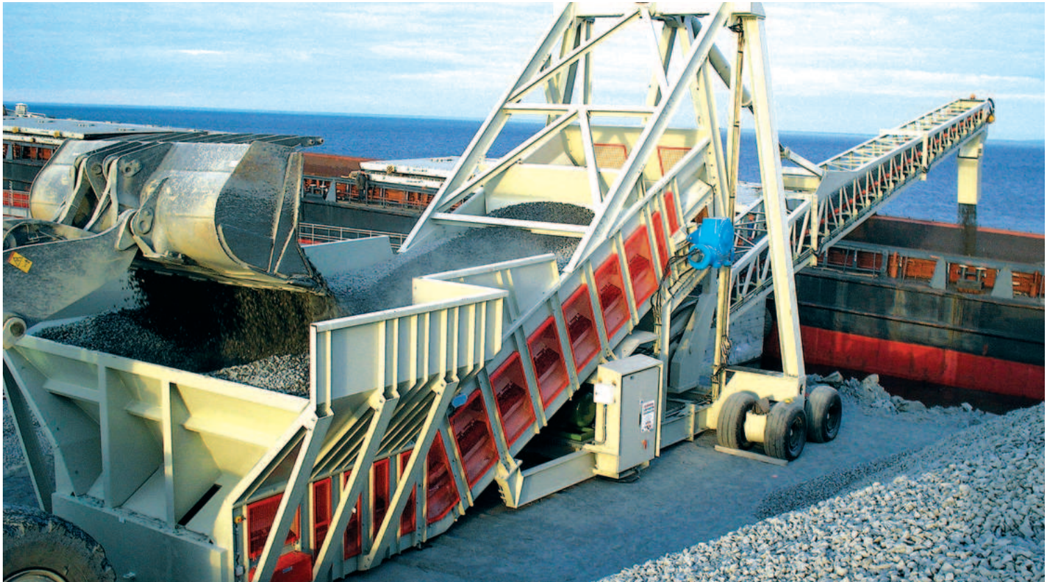
Массивный питатель-конвейер Stormajor® BF1627W принимает габро породу для перегрузки на баржи, производительность 1.000 т/ч
