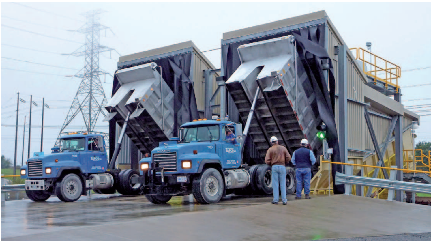
Два питателя Samson® принимают известняк фракции до 25 мм для системы обессеривания на электростанции в США.
