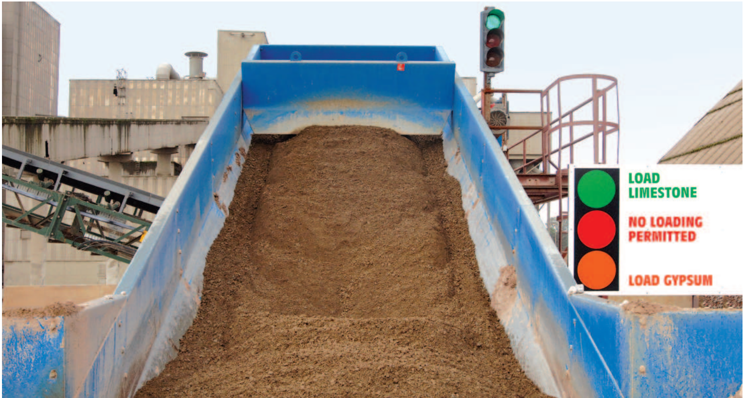
Материал внутри бункера питателя Samson® может иметь различную высоту слоя по всей длине бункера
