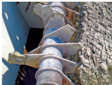
Роторный рыхлитель обеспечивает дозированную подачу влажной глины
