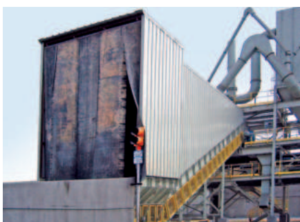
Увеличенная наклонная секция питателя для повышения складирующего объема или увеличения высоты передачи материала
