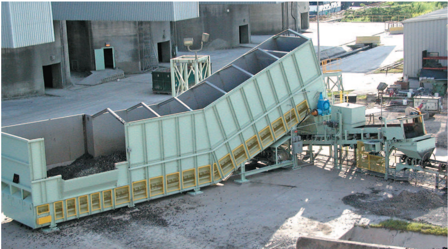
Питатель Samson® серии MF08 обеспечивает 100 м³ рабочего складирующего объема для альтернативного топлива на цементном заводе
