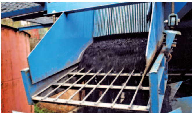
Вибропитатель с наклонным ситом для отсеивания крупнокускового материала
