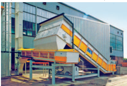
Ленточный питатель передает материал в ковшовый элеватор
