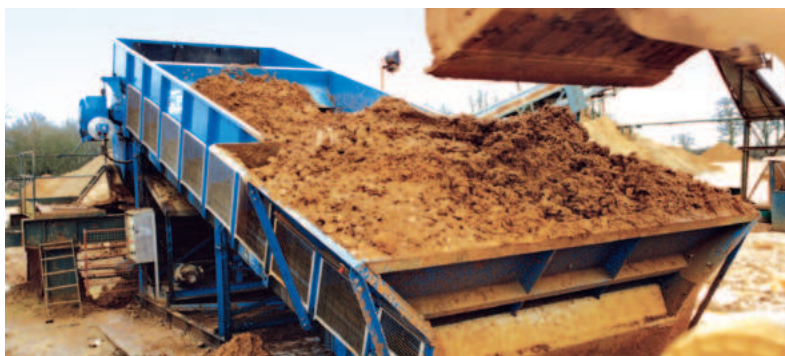
Samson® с прямым корпусом и расширенным приемным бункером (ширина 4,5 м) принимает суглинки с экскаватора
