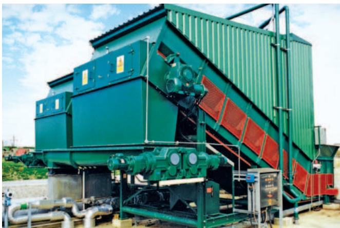
Двойной шнек дозирует материал в винтовой насос
