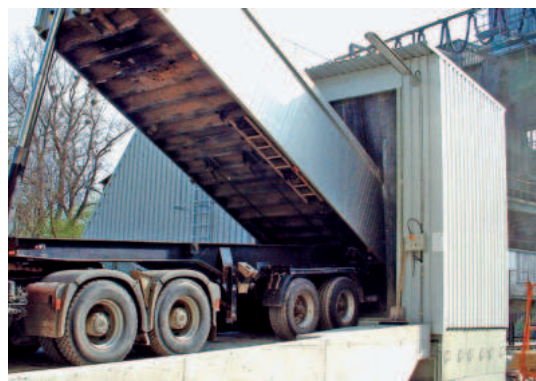
Питатель Samson® с боковой загрузкой принимает клинкер для передачи в существующую транспортную систему
