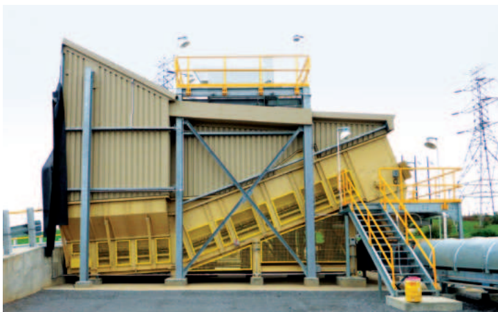
Наклонная секция питателя Samson® позволяет выгрузку на наземный конвейер
