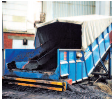
Частичное укрытие питателя из полихлорвинилового материала
