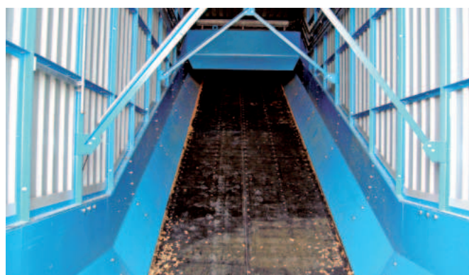
Принцип пластинчато-ленточного питателя 3-х метровой ширины идеален для трудно-обрабатываемых грузов
