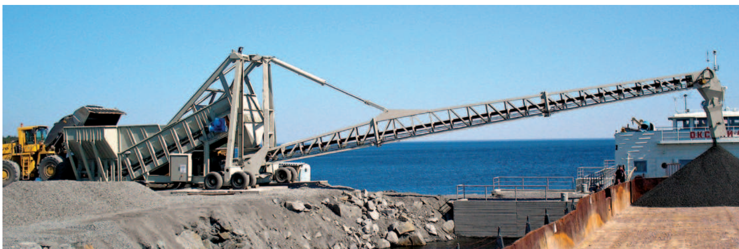
Укладчик Stormajor®, с интегрированным питателем Samson® серии 1600 и поворотной стрелой для загрузки барж
