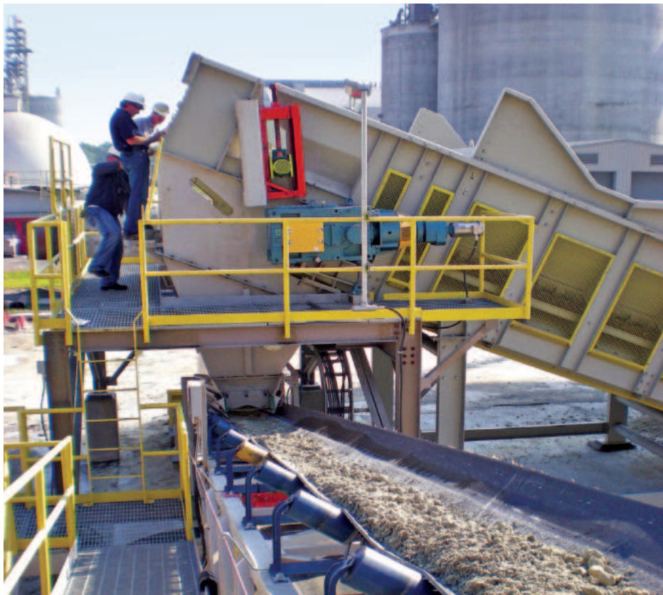
Питатель Samson® серии MF16 с двойными косозубыми коническими передачами расположенными по обоим сторонам ведущего вала
