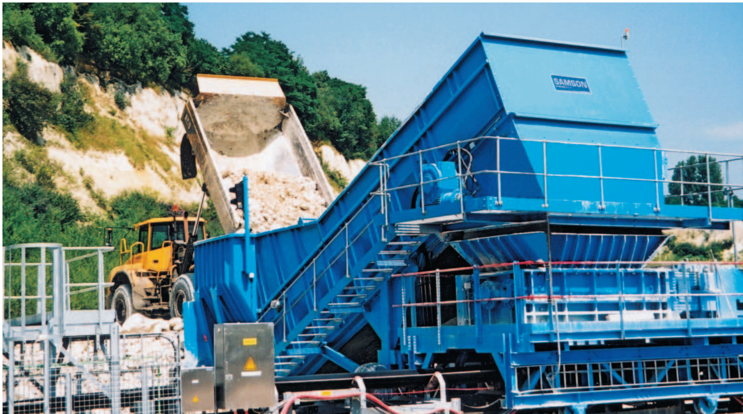
Сдвоенная роторная дробилка принимает с питателя Samson® несортированный известняк из карьера для дробления и последующей передачи на ленточный транспортер
