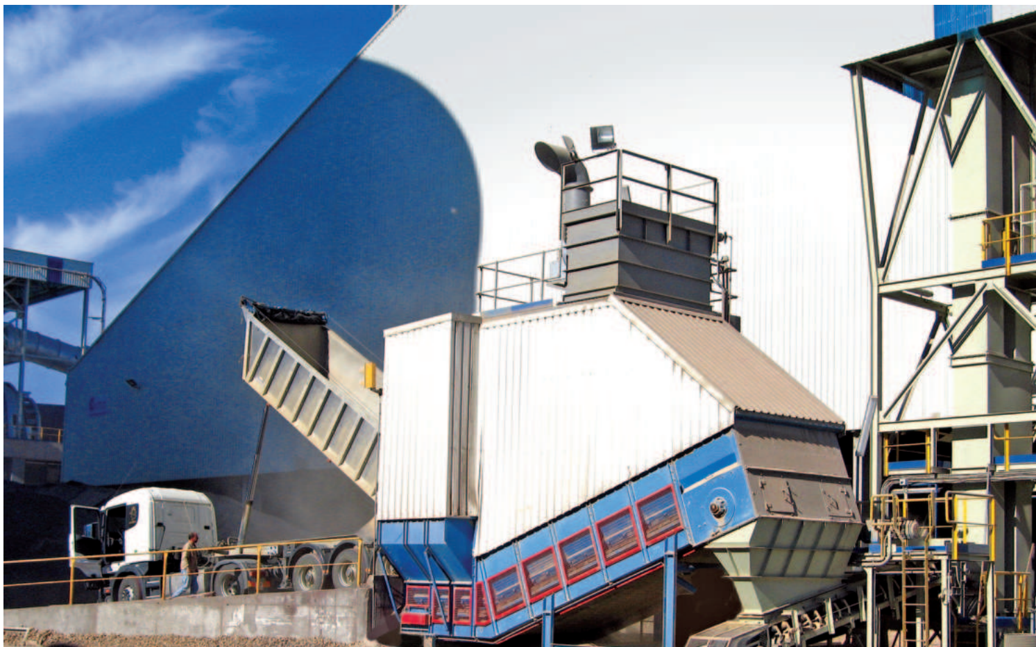
Питатель Samson® с изогнутым корпусом и полным укрытием, включая аспирационные фильтры, на приеме цементного клинкера
