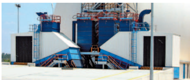
Два питателя Samson® с боковой разгрузкой подающие цементный клинкер на верхнюю точку кругового склада через ковшевые элеваторы
