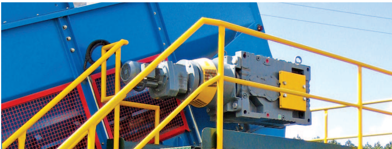
Высокоэффективная косозубая коническая передача с первичной понижающей передачей
