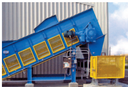
Подача синтетического гипса из питателя на горизонтальный конвейер
