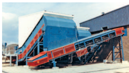
Питатель Samson® с горизонтальным накопительным бункером и подвесным транспортером со скребковым разгрузителем
