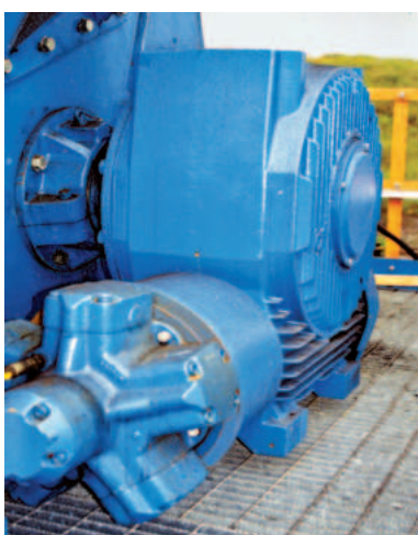
Высокоэффективная косозубая коническая передача с первичной понижающей передачей
