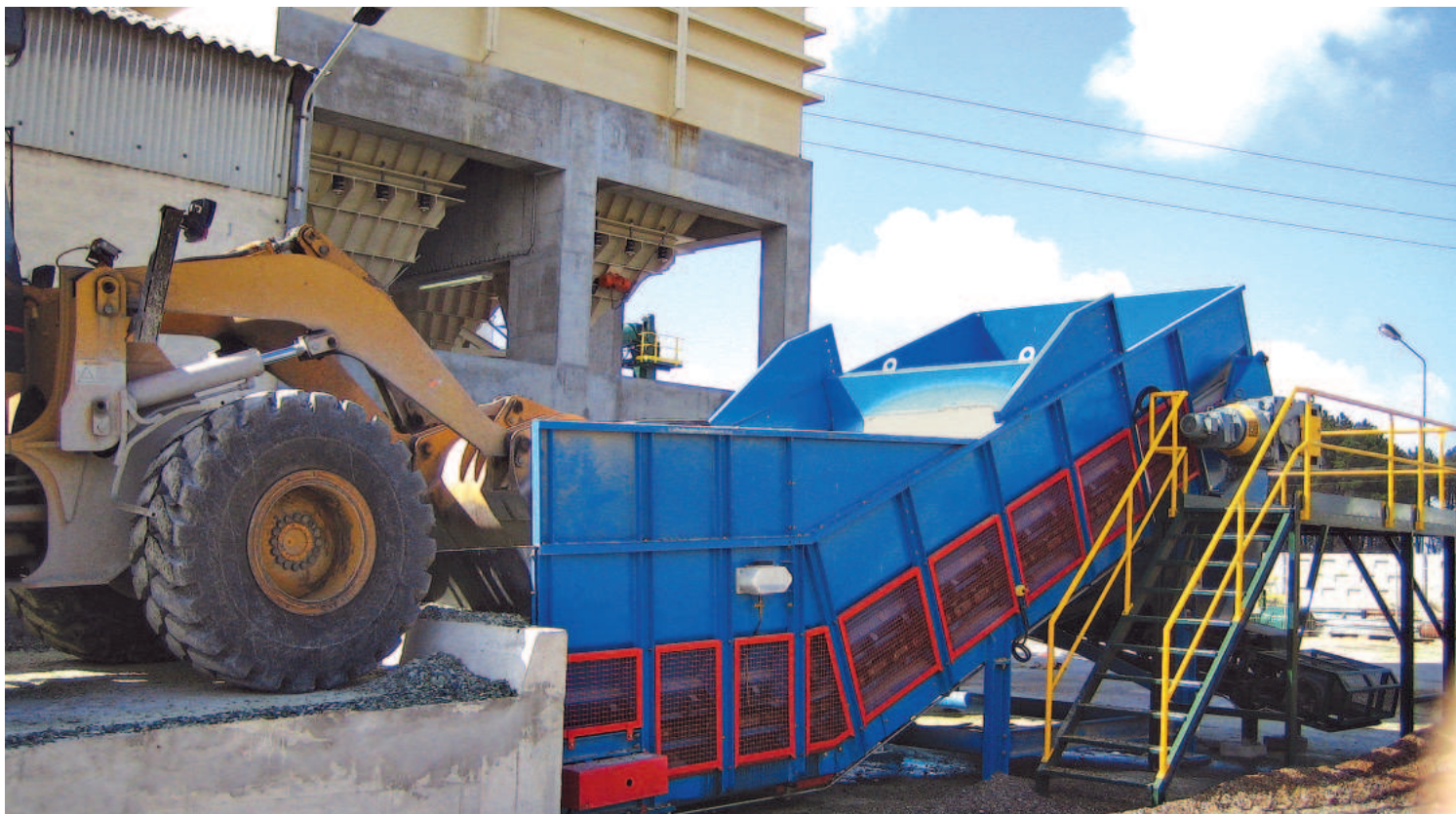
Samson® с изогнутым корпусом и параллельным приемным бункером (ширина 3 м) принимает битое стекло с самосвалов или экскаваторов
