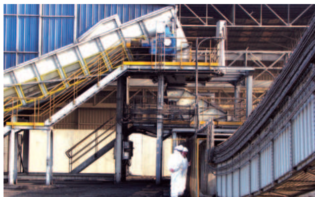
Питатель Samson® с виброситом для отсева крупнокускового материала перед передачей на следующей транспортер
