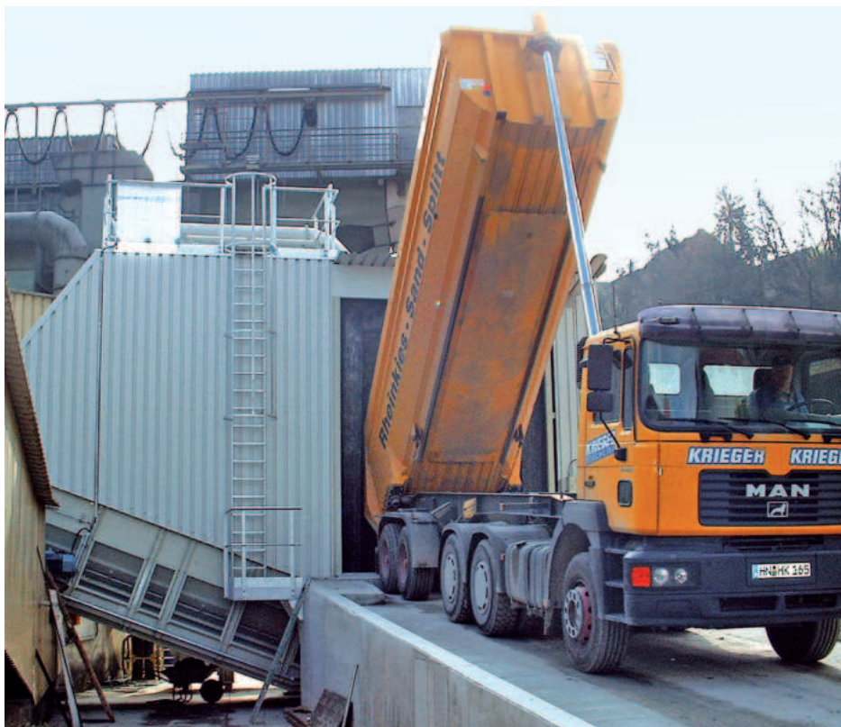
Питатель Samson® с боковой загрузкой принимает клинкер для передачи в существующую транспортную систему
