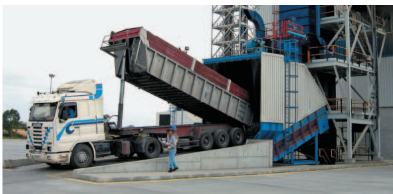
Разгрузка самосвалов с цементным клинкером в питатель Samson® с интегрированной системой фильтрации пыли
