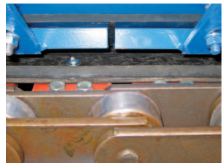
Нагрузка ложится на ролики цепи.
