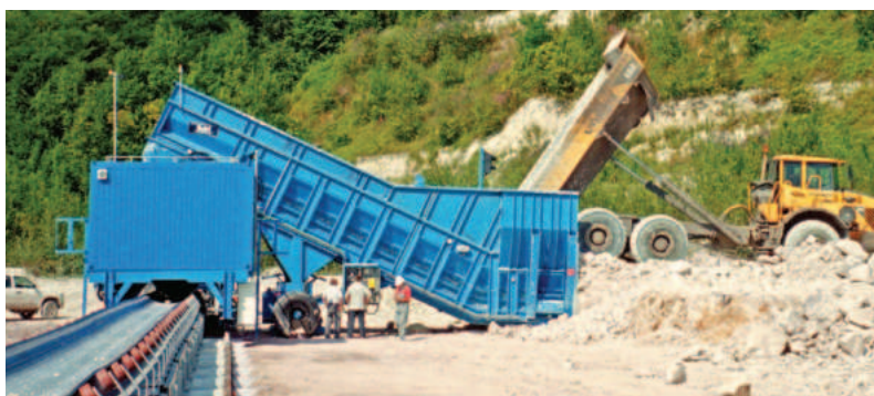
Передвижной Samson® в карьере со встроенным классификатором принимает материал с самосвала
