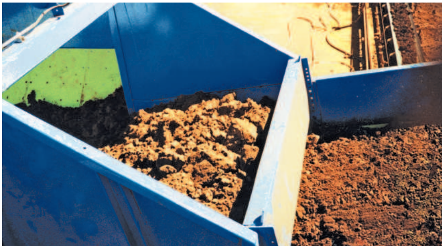
Ограничительный скребок контролирует высоту слоя на входе в разгрузочную головку питателя Samson®
