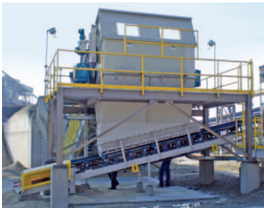
Питатель Samson® серии MF16 с двойными косозубыми коническими передачами расположенными по обоим сторонам ведущего вала
