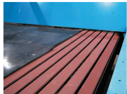
Металлические планки несут весовую нагрузку
