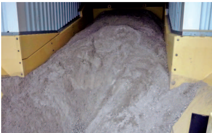
Наклонная секция питателя Samson® позволяет выгрузку на наземный конвейер
