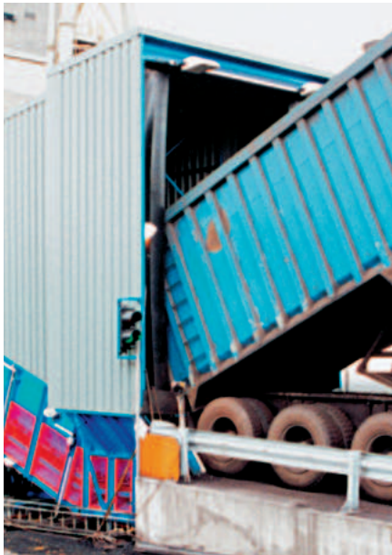
Конструкция с широкой лентой исключает сводообразование
