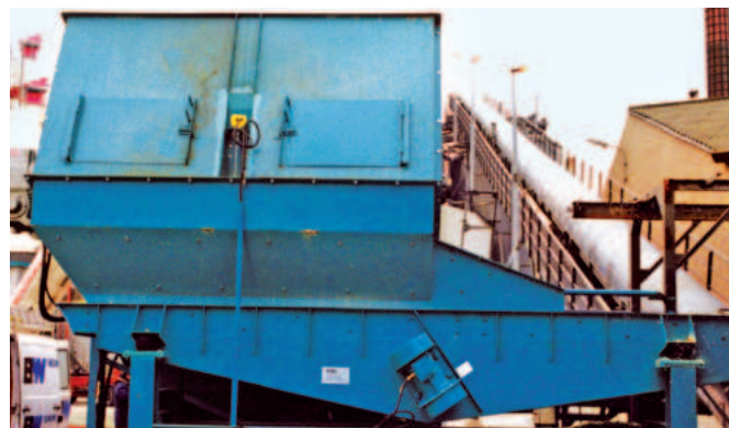
Вибропитатель обеспечивает равномерную подачу на наклонный ленточный транспортер
