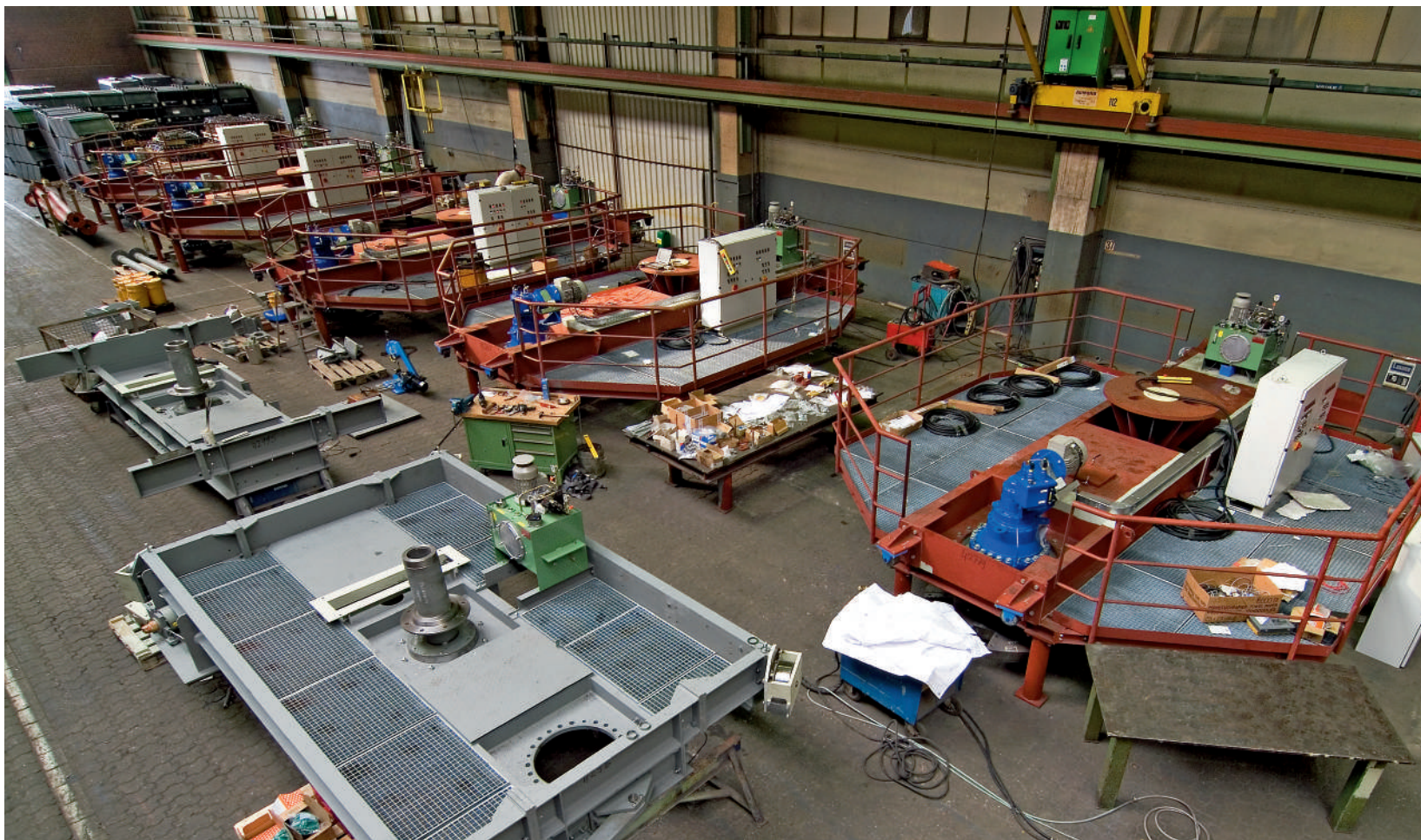
5 бункерных разгрузочных механизмов кругового типа BEW-K 10.000/4.500 во время сборки на заводе.
