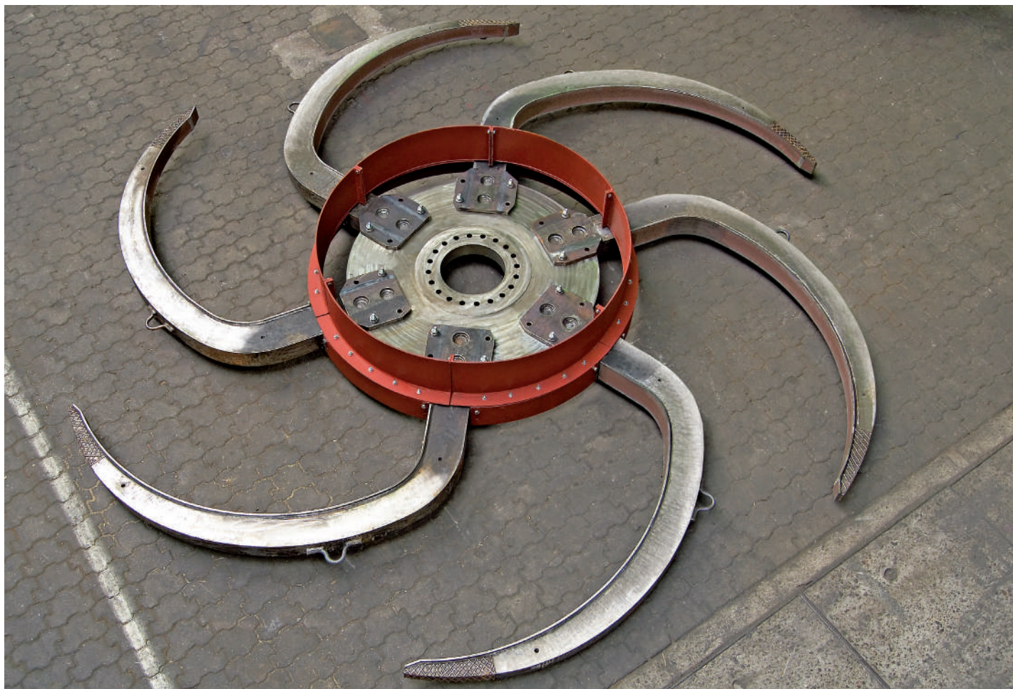
Разгрузочное колесо для бункерного разгрузочного механизма кругового типа ВЕW-К, диаметр 4.500 мм
