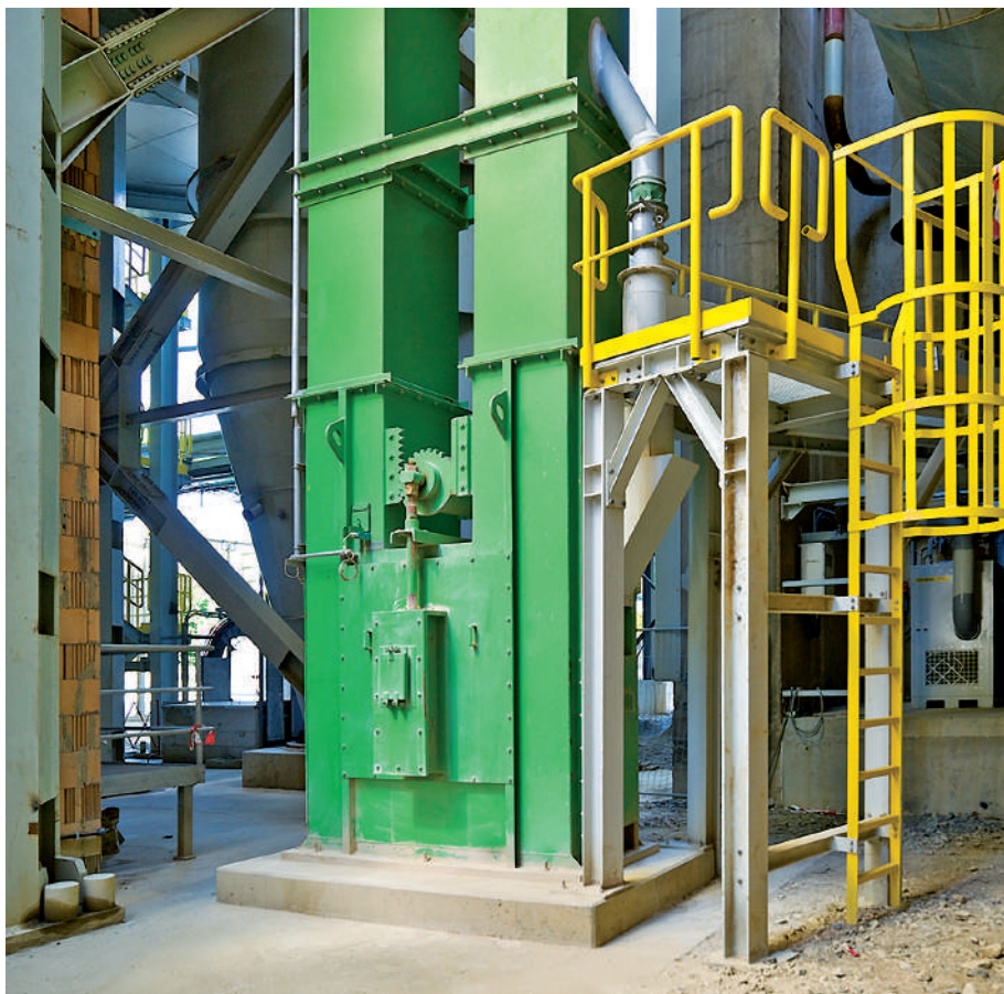
Башмак элеватора с натяжным устройством для контроля параллельного хода ленты
