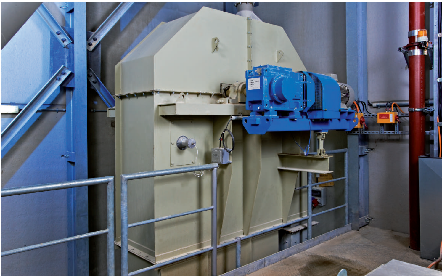
Головка ковшового элеватора с одним приводом
