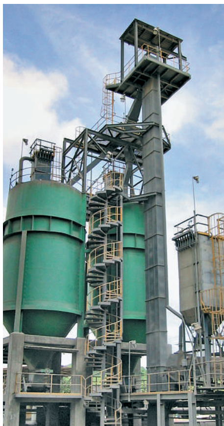
Ковшовый элеватор типа BWZ, транспортирующий пуццолан и известняк
