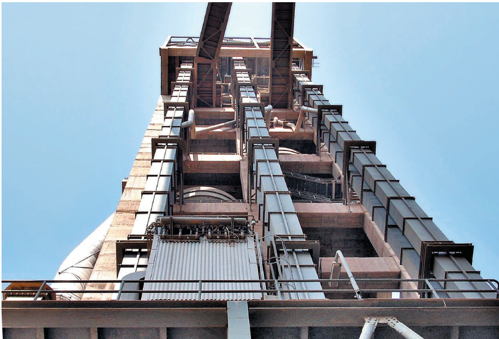
Ленточный ковшовый элеватор для подачи сырьевой муки
