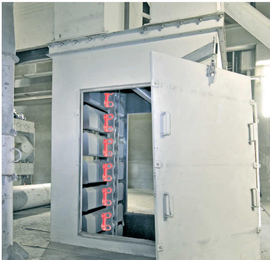
Монтажная шахта элеватора с дверцей на шарнирах для простоты технического обслуживания
