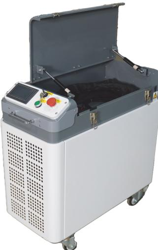
Импульсная лазерная очистка – это деликатная очистка с помощью коротких, но мощных лазерных импульсов. В отличие от постоянной (непрерывной) лазерной очистки, импульсная очистка воздействует кратковременными всплесками энергии, испаряя загрязнения без перегрева.
