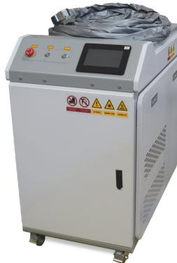
Постоянная (непрерывная) лазерная очистка – это очистка с помощью непрерывного лазерного излучения. В отличие от импульсной чистки постоянную можно назвать грубой чисткой с высокой мощностью и с меньшим количеством настроек. Постоянное излучение шириной до 45 см. нагревает материал, быстро испаряя или сжигая загрязнения.
