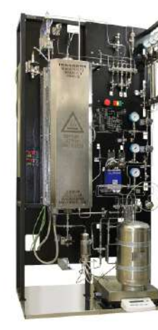
Автоматизированная лабораторная установка тестирования катализатора дегидрирования изобутана (КДИ, КДИ-М) в псевдооживленном слое
