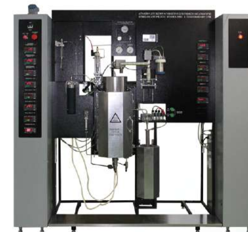
Установка для оценки активности и селективности катализаторов флюид-каталитического крекинга (ФКК) в псевдооживленном слое
